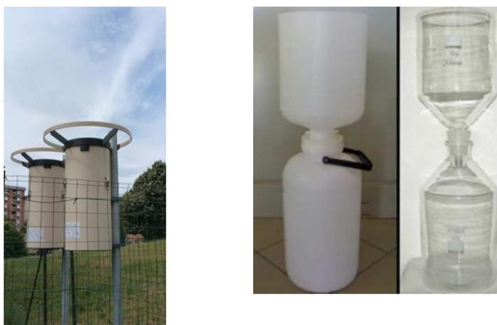
Figura 3 – Deposimetri in configurazione di prelievo.
